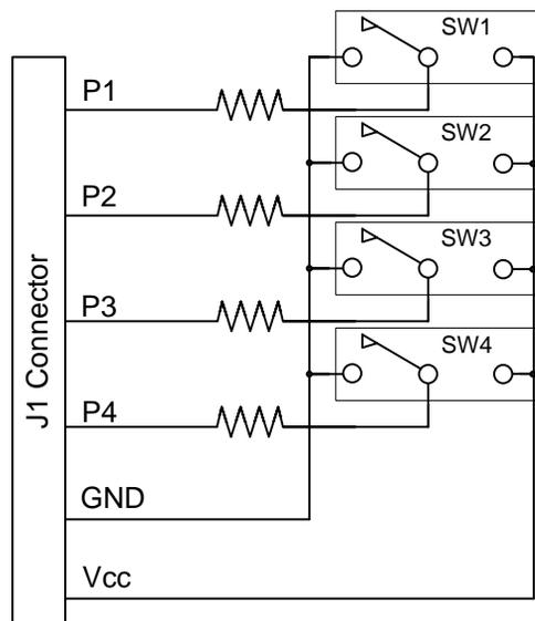
**Switch Module Circuit Diagram**
